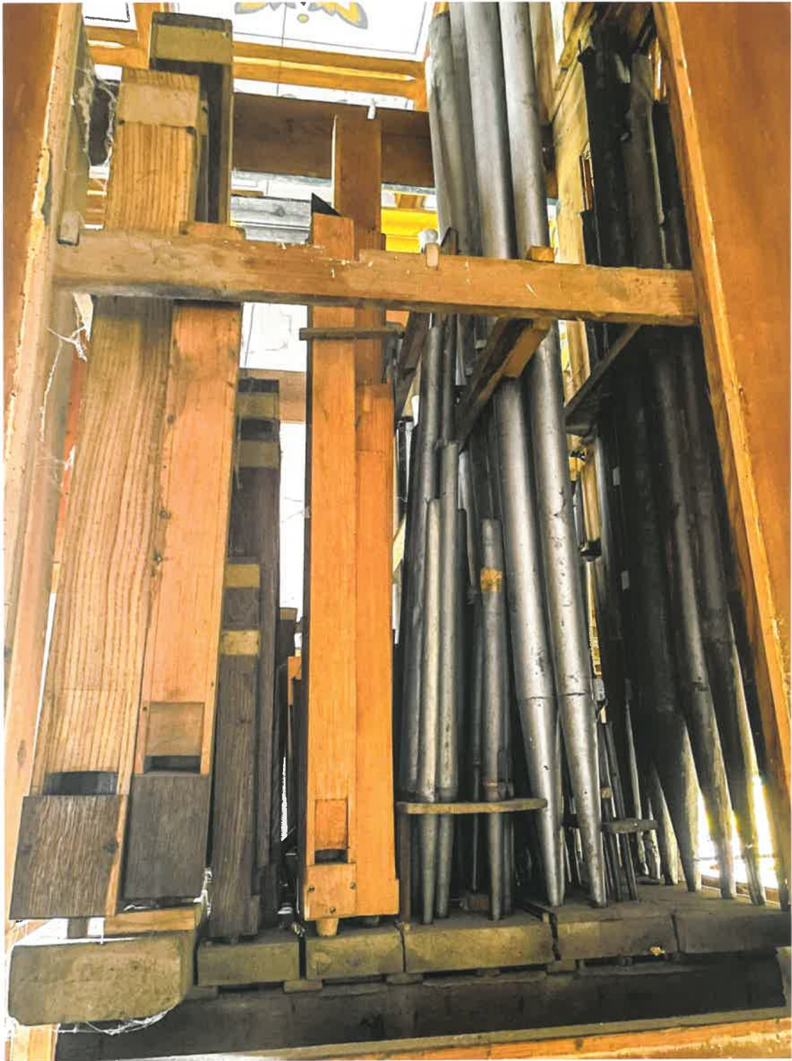
Fotografia nr 19 – Materiał puszczalkowy; widoczne zasuwki, kloce, przykręcane forszałgi, dwa rodzaje montowania listew stabilizacyjnych puszczalek, ławeczki oraz odchylone od pionu korpusy puszczalek; gierowanie największych tonów Gamby (autor – FP, 2024 r.)
