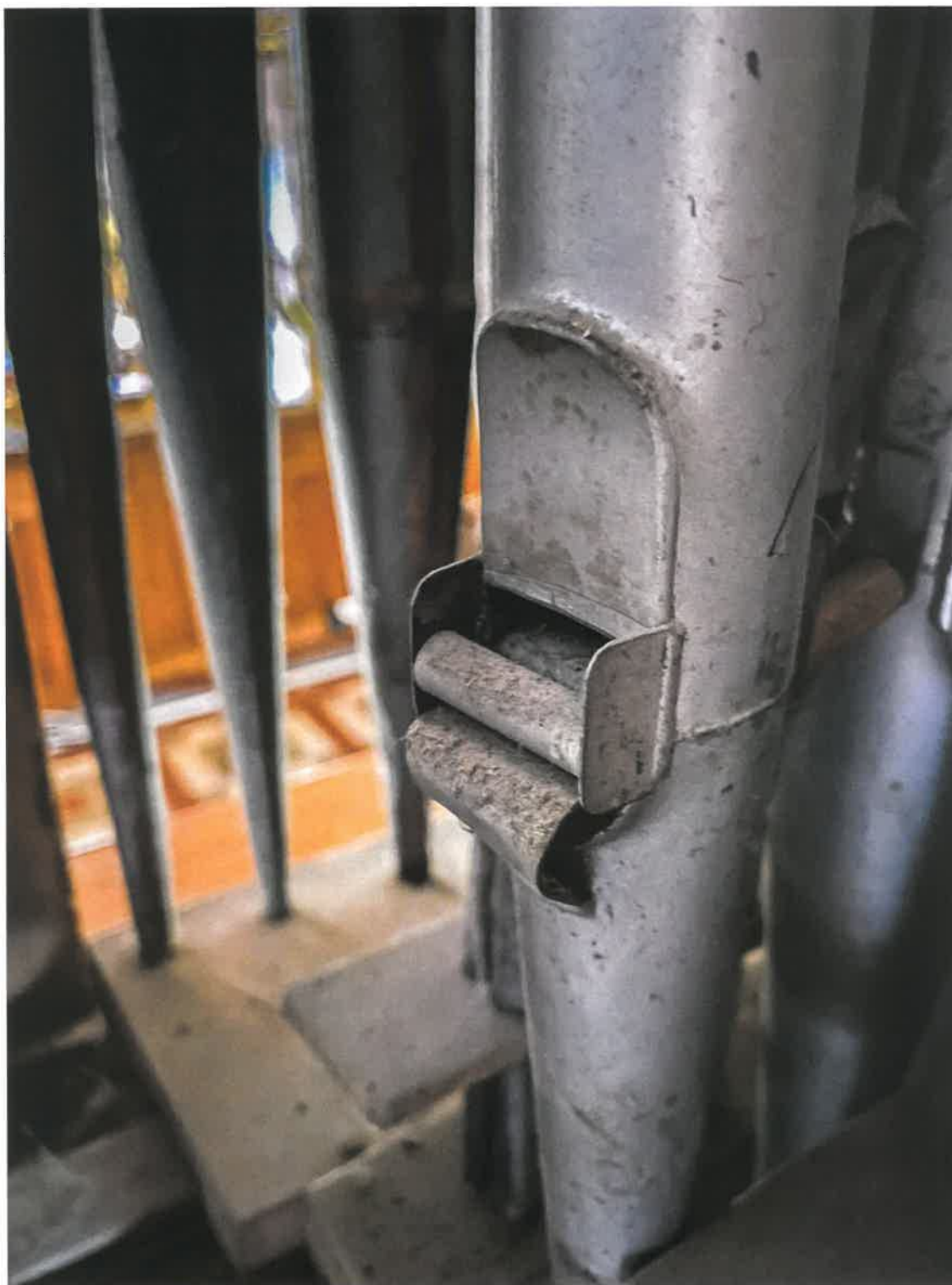
Fotografia nr 21 – Piszczalka smyczkowa; pomoce intonacyjne w postaci baczków, bródki i wałka (autor – FP, 2024 r.)
