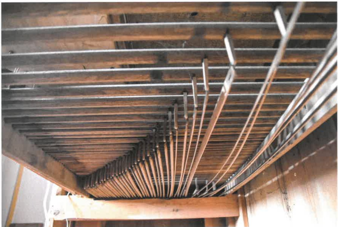
Fotografia nr 26 – Traktura gry, wałki skrzytne oraz przymocowane do nich drewniane abstrakty (autor – FP, 2024 r.)
