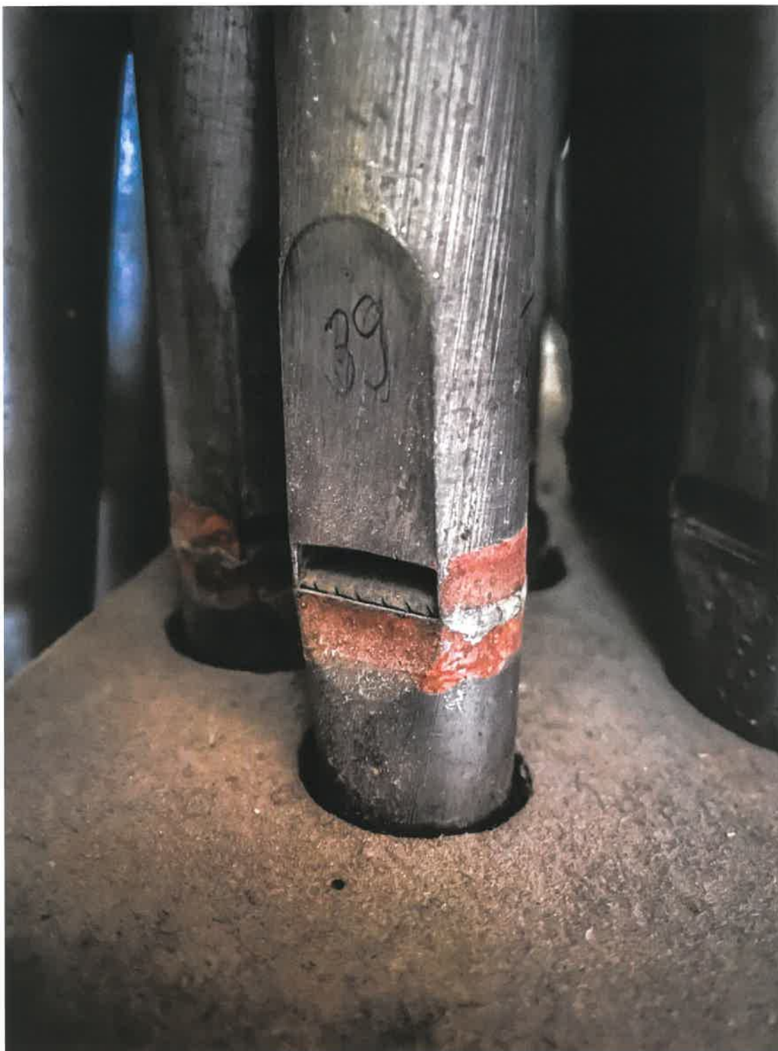
Fotografia nr 20 – Metalowa piszczałka 2-stopowej oktawy z charakterystyczną strukturą metalu, formą labium, farbą bolusową, ostrym kątem (fazą) rdzenia, brakiem dopasowania średnicy otworu w ławeczce ( autor – FP, 2024 r.)
