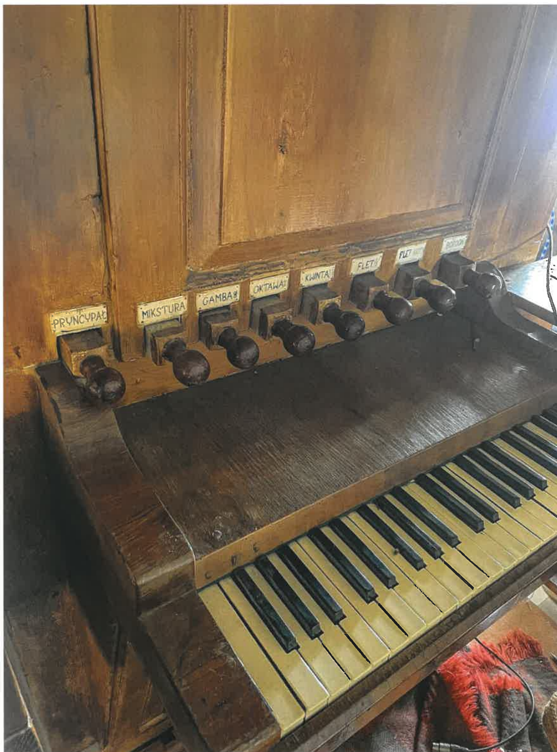
Fotografia nr 27 – Klawiatura manualowa oraz ciągła rejestrowe wraz z tabliczkami (autor – FP, 2024 r.)
