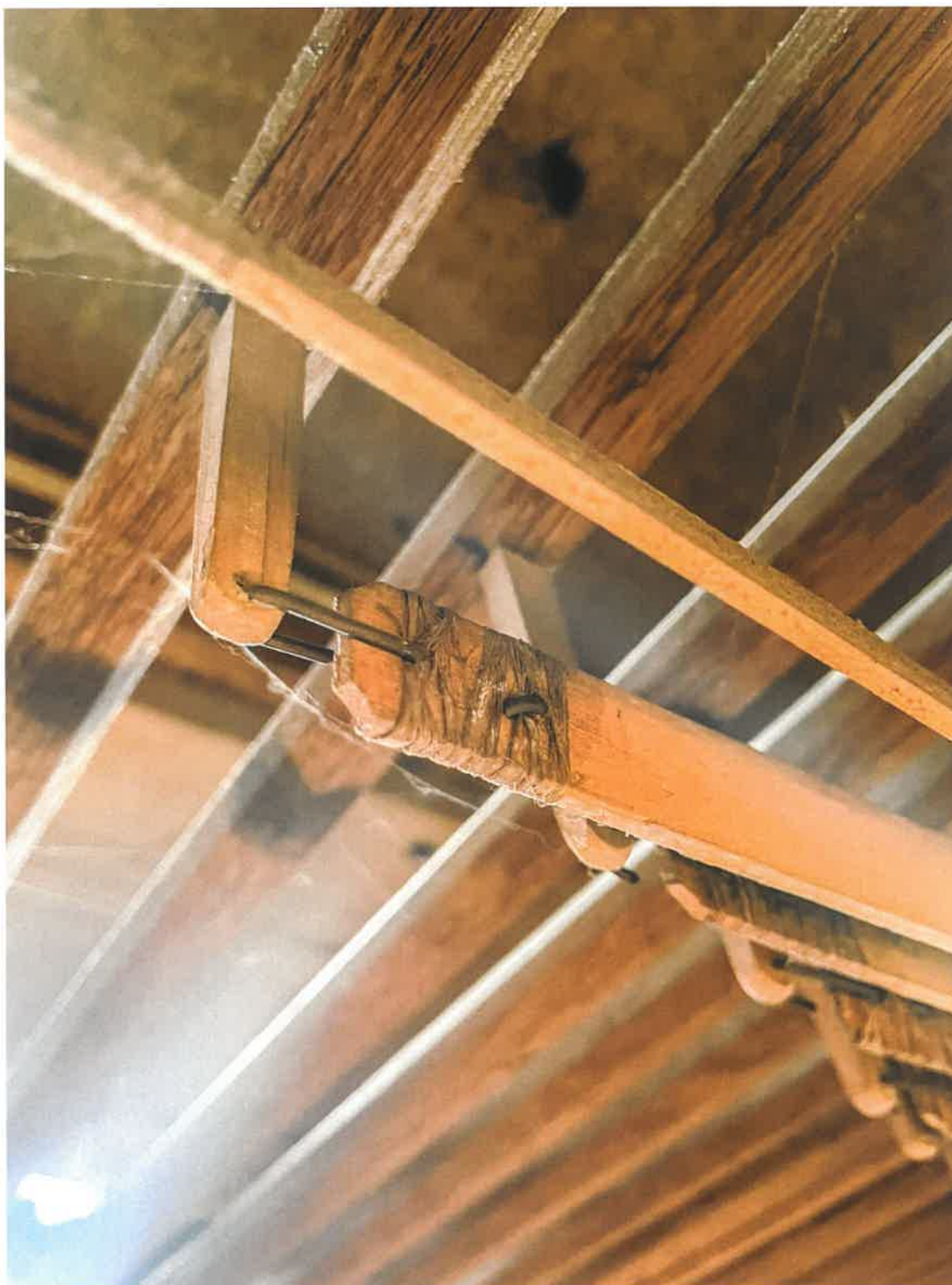
Fotografia nr 24 – Połączenie ramiona waleka z abstraktem, owinięcie końcówki pakułą (autor – FP, 2024 r.)
